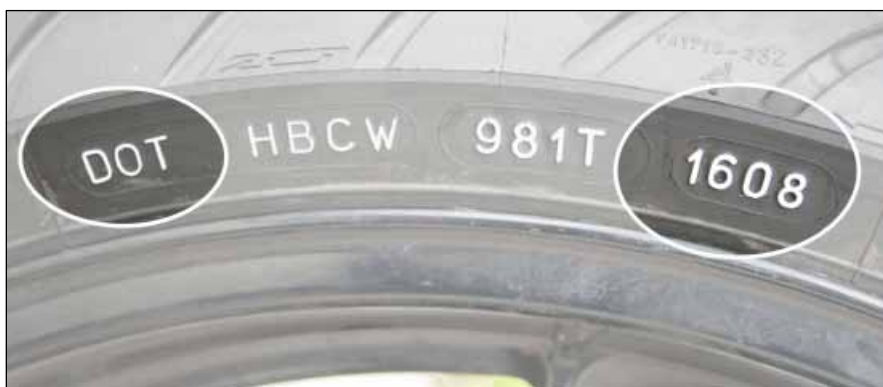
Bild 5: Die DOT-Nummer enthält viele verschlüsselte Daten, das Herstellungsdatum ergibt sich aus den letzten vier Stellen.
