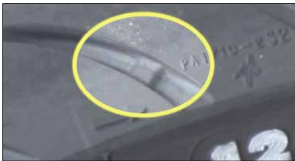
Bild 4: Der Verschleißzustand des Reifens lässt sich an dem sogenannten „Treadwear Indicator“ (TWI) erkennen.
